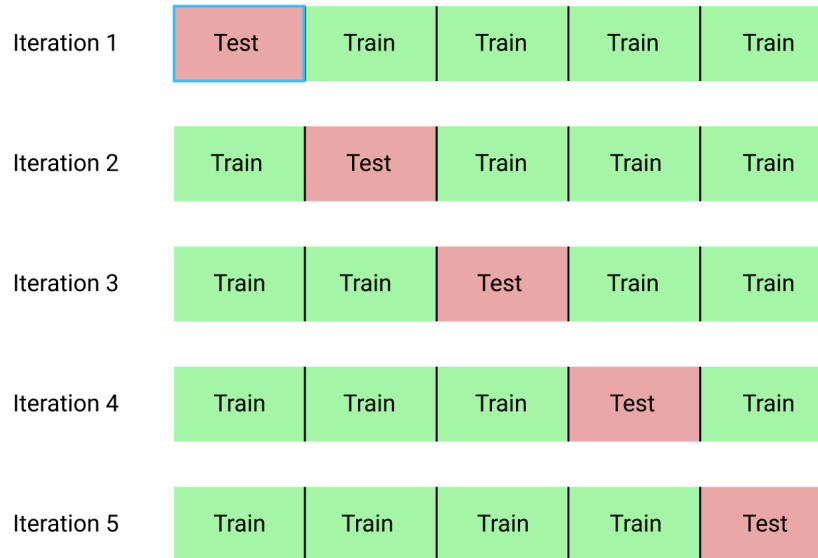
FIGURE 4.1 – Validation croisée en k = 5 parties. Tour à tour, chacune des 5 parties est utilisée comme sous-échantillon pour tester le modèle prédictif. L’union des 4 autres parties est utilisée comme sous-échantillon pour entraîner le modèle.
