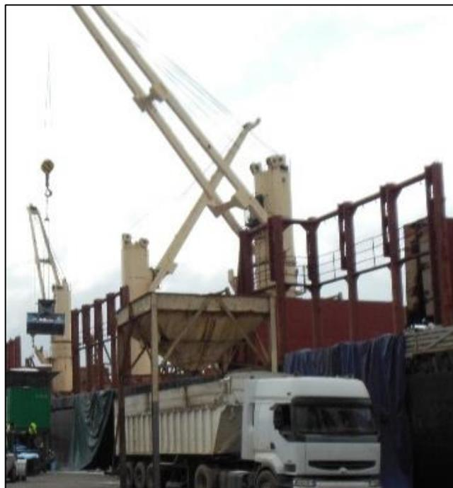
*Figure 3.12. Illustration du déchargement par entonnoir au port d'Abidjan*
