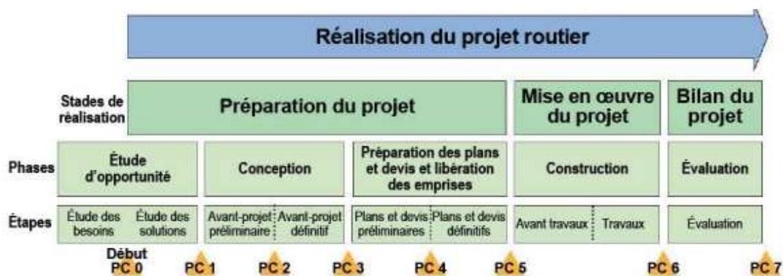
Figure 2 : Cheminement ministériel de la réalisation de projets routiers.
